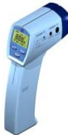
**1.1 工作原理：**任何物体当它的温度高于绝对零度时，都向外辐射红外线。红外线是一种电磁波，具有很强的温度效应，其能量的大小与物体表面的温度有着十分密切的关系。TI 130 红外测温仪的工作原理就是根据物体的这种红外辐射特性，通过透镜汇聚红外能量到传感器，传感器再把热能转换成电信号，微处理器对电信号进行处理后，转换成温度值显示在液晶屏上。
